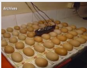
Bild 3: Die mit dem GSM-900-Mobiltelefon bestrahlte Gruppe von 60 Eiern
