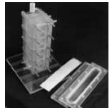
Die 3-Kammer-Membran-Elektrolyse-Zelle (oben) mit einer geöffneten Kammer (unten). Die Zelle ist 17 cm hoch.
