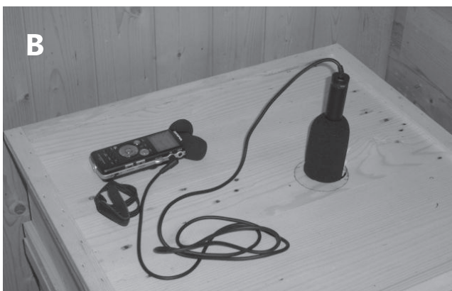
Bild 1: Anordnung des Mikrophons zur Aufzeichnung der Bienengeräusche am Flugloch (A) oder durch die Fütterungsöffnung (B).
