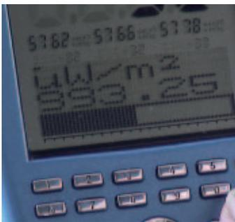
Bei Einstellung „Pulse“ und Span von 5760 - 5780 MHz findet der Spectran HF 6080 Rev.3 Geisterfrequenzen, bis zu  $993\mu\text{W}/\text{m}^2$ , die in Wirklichkeit gar nicht vorhanden sind.
